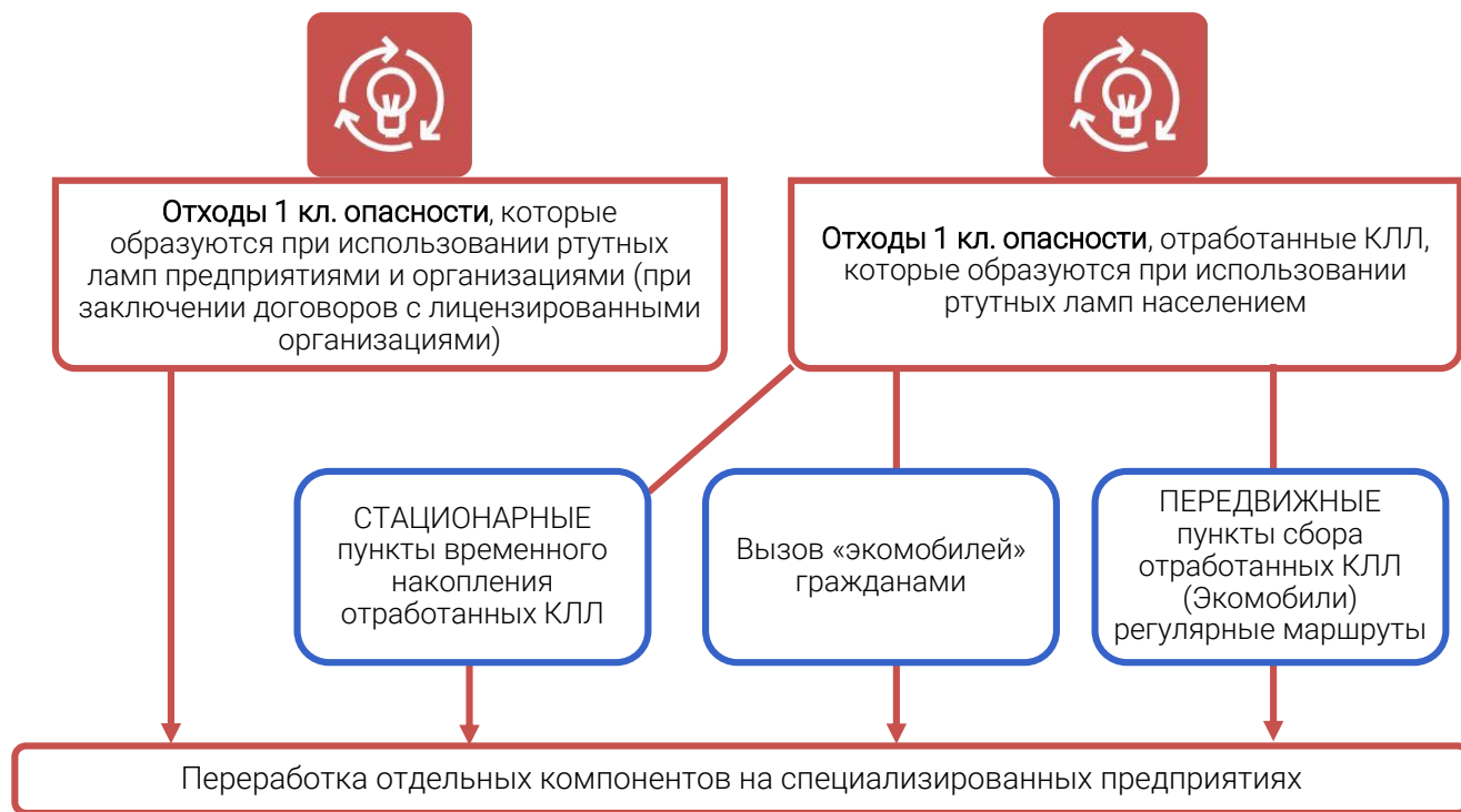
Рисунок 4.2 – Возможная система обращения с ртутьсодержащими отходами
